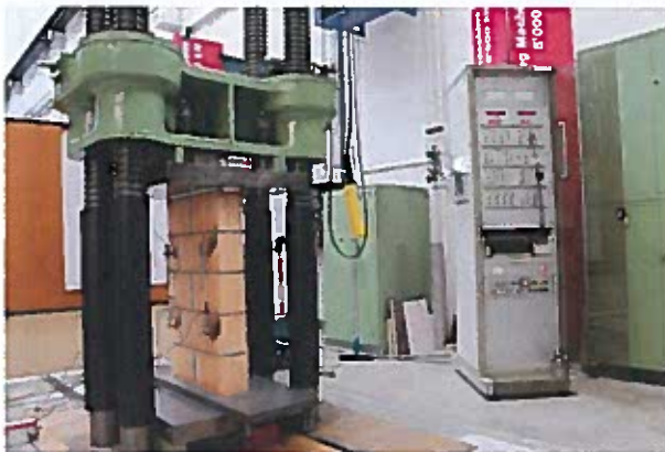
Abbildung 3: Mauerwerkskleinkörper 3.1 in der 5'000 kN Druck-Prüfmaschine eingebaut.
