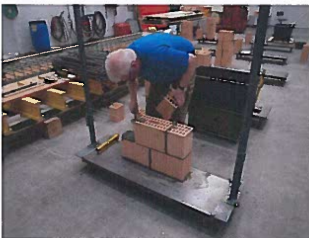
Abbildung 1: Aufmauern eines Mauerwerkskleinkörpers der ersten Prüfserie.
