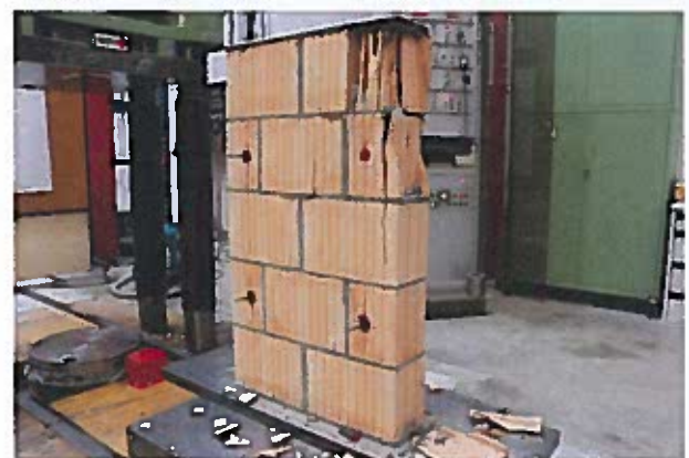
Abbildung 10: Mauerwerkskleinkörper Nr. 3.3 nach Versuch. Nach Abbau der Weggeber und aus der Prüfmaschine herausgefahren.
