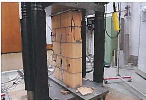
Abbildung 9: Mauerwerkskleinkörper Nr. 3.3 nach Versuch.
