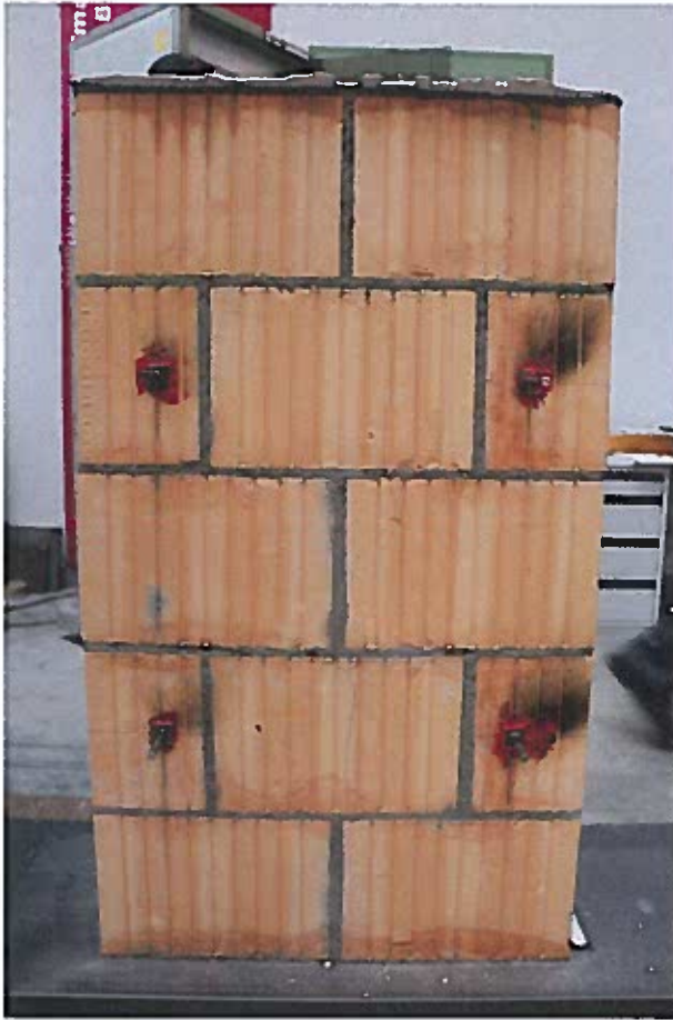
Abbildung 7: Mauerwerkskleinkörper Nr. 3.1 nach Versuch. Sichtbare vertikale Risse. „Vorderseite“.
