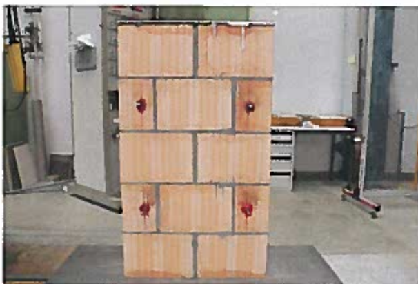
Abbildung 5: Mauerwerkskleinkörper Nr. 3.2 nach Versuch. Keine Schäden sichtbar.
