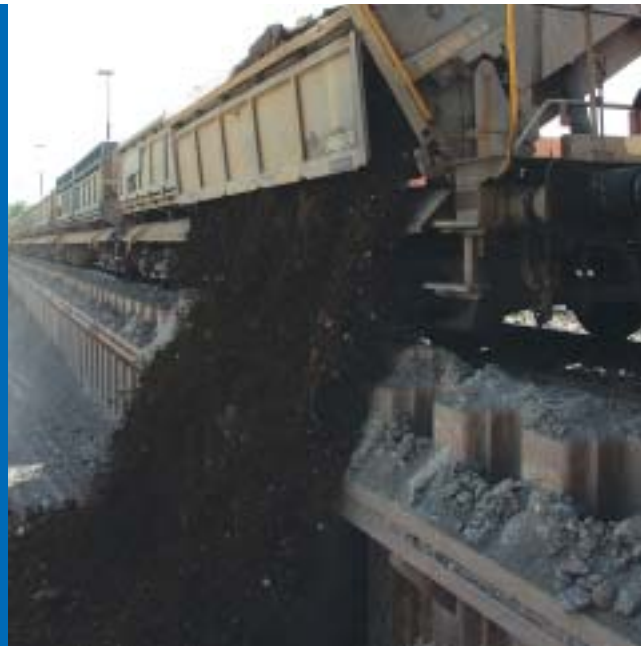
Für verwohnen angeliefertes Material wird der Frachtbrief der SBB übernommen, unverwohne Anlieferungen werden auf Lastwagen geladen und gelangen über die «Strasse» via Waage in die Deponie.
