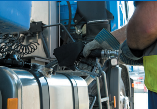
Bild oben: Transponder, direkt am Einfüllstutzen angebracht Bild unten: mit Sender ausgerüstete Zapfpistole
