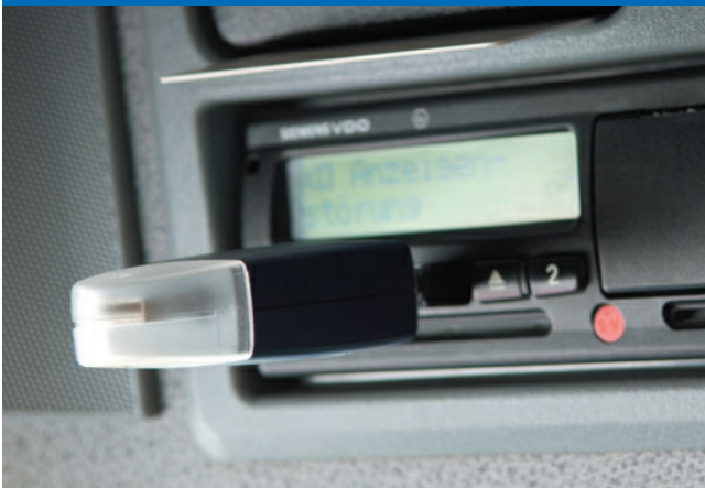
Bild oben: die Fahrerkarte wird in den Tachographen gesteckt Bild unten: Download-Key für die quartalsweise Datensicherung
